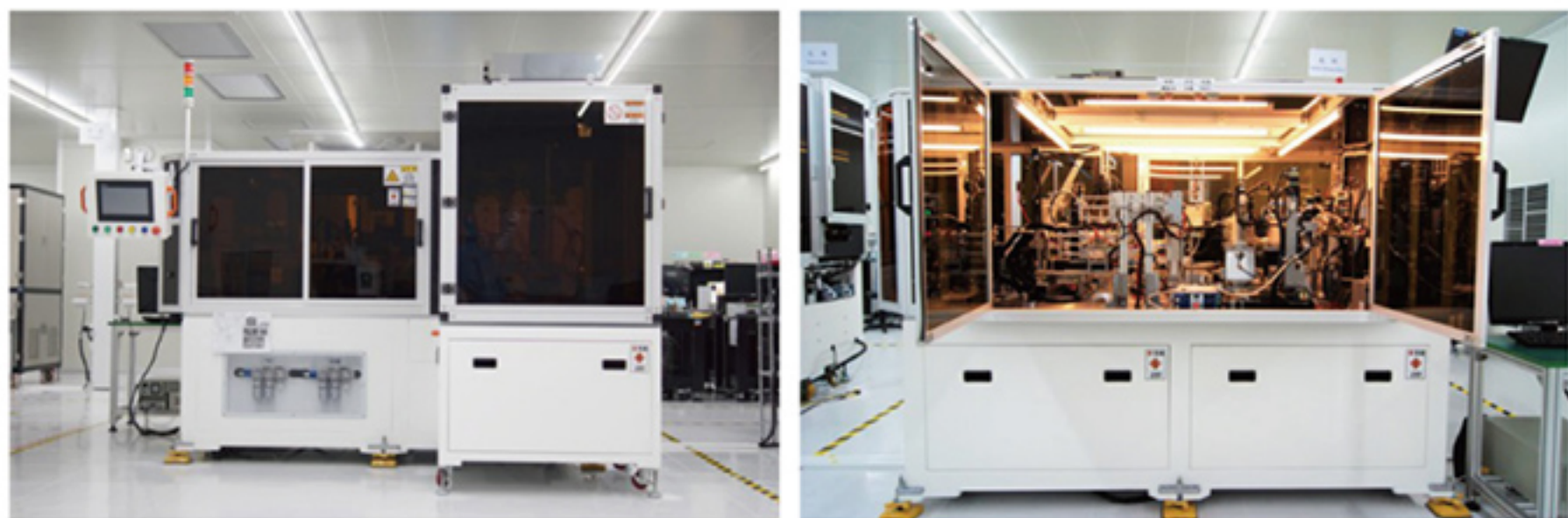
英錡科技自主研发的自動化產線，已具備成像模組規模量產能力
